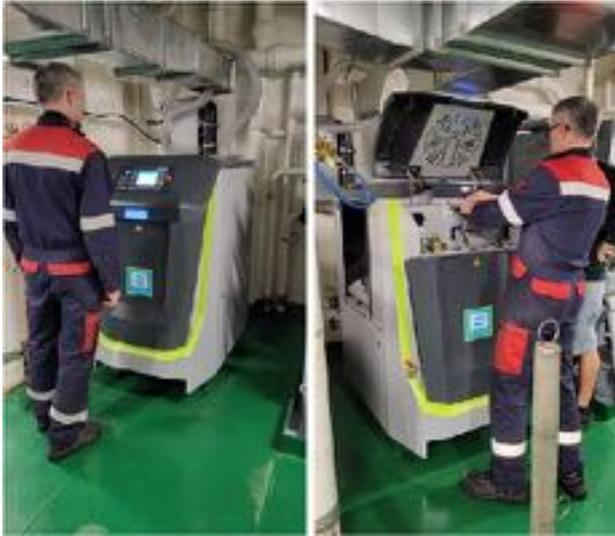
Le compresseur Air et Nitrox, il faut purger le système pour passer du Nitrox à l'air et le choix se fait en ouvrant le capot.
